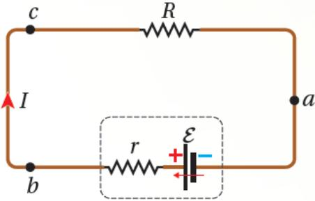
تعرف تغيرات الجهد عبر ملامح دارة بسيطة مثل المبينة في الشكل الطجاور سوف التحرك باتجاه دوران عقارب الساعة بدءاً من النقطة (a) التي تمثل قطب البطارية السالب. حتى أكمل العروة كاملة بالعودة إلى نقطة البداية (a) يملتنج تمثيل التغيرات في الجهد الكهربائي التي سأوجدها بياناً كما في الشكل التالي
