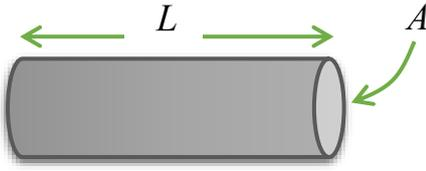
العوامل المؤثرة على مقدار المقاومة الكهربائية
