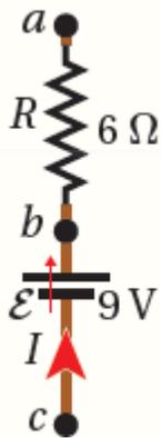
بيّن الشكل المجاور جزءًا من دائرة كهربائية، بالاعتماد على بيانات الشكل، حيث إن:  $(V_c - V_a = 7V)$ ,  $(V_b - V_a = 15V)$  أجد مقدار المقاومة الداخلية للبطارية.
