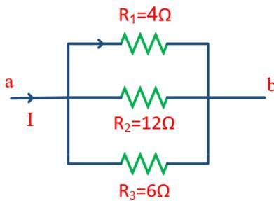
بالاعتماد على الشكل المجاور إذا علمت أن مقدار التيار الكهربائي اطار في المقاومة الأولى
