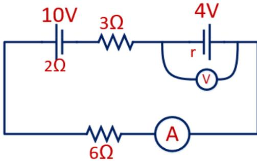
يبين الشكل المجاور دائرة كهربائية بسيطة معتمدا على الشكل وبياناته، إذا علمت أن قراءة الفولتميتر (V) تساوي (4.5V) احسب قراءة الأميتر (A).
