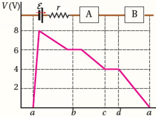
تتكوّن دائرة كهربائية من بطارية لها مقاومة داخلية ومقاومتين خارجيتين، يمرُّ فيها تيار كهربائي (1.6A) بالاتجاه من (a) إلى (a). مُثِّلت تغييرات الجهد فيها بيانياً، كما في الشكل المجاور، أجد ما يأتي:
