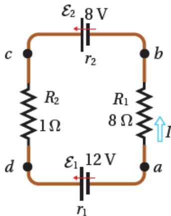
دارة كهربائية بسيطة تتكوّن من بطارتين ومقاومتين، كما في الشكل المجاور إذا كانت كلتا المقاومتين الداخليتين تساوي (0.5Ω) باستخدام القاعدة الثانية لكيرشوف؛ أجد قيمة التيار وأحد اتجاهه.
