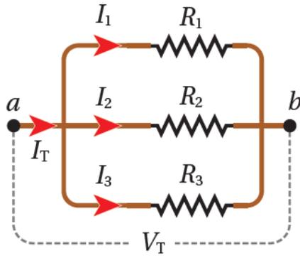
إحدى طرق توصيل المقاومات في الدارات الكهربية هي التوصيل على التوازي كما في الشكل التالي :
