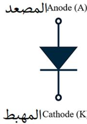
الشكل المجاور يبين تركيب الثنائي البلوري ورمزه المستخدم في الدارات الكهربائية، حيث ان البلورة الموجبة تسمى **مصعد** والبلورة السالبة تسمى **المهبط**
