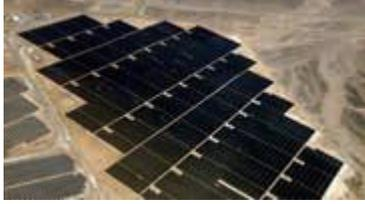
يعتمد مبدأ عمل كثير من الأجهزة والأدوات في وقتنا الحاضر على الظاهرة الكهروضوئية، حيث تُحوَّل طاقة الفوتونات إلى طاقة كهربائية. وتُعدّ الخلايا الشمسية من المصادر البديلة النظيفة للطاقة، أتأمل الشكل أدناه، حيث تحوّل الطاقة الشمسية إلى طاقة كهربائية. وقد تصل فاعليّة الخلايا الشمسية المستخدمة للأغراض التجارية إلى 20% تقريبًا.
